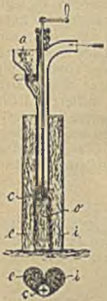
Kl. 5, Nr. 65004, vom 27. Januar 1892. Fr. Großmann in Preussnitz bei Biendorf. Herstellung fester Stöße in schwimmendem Gebirge.
