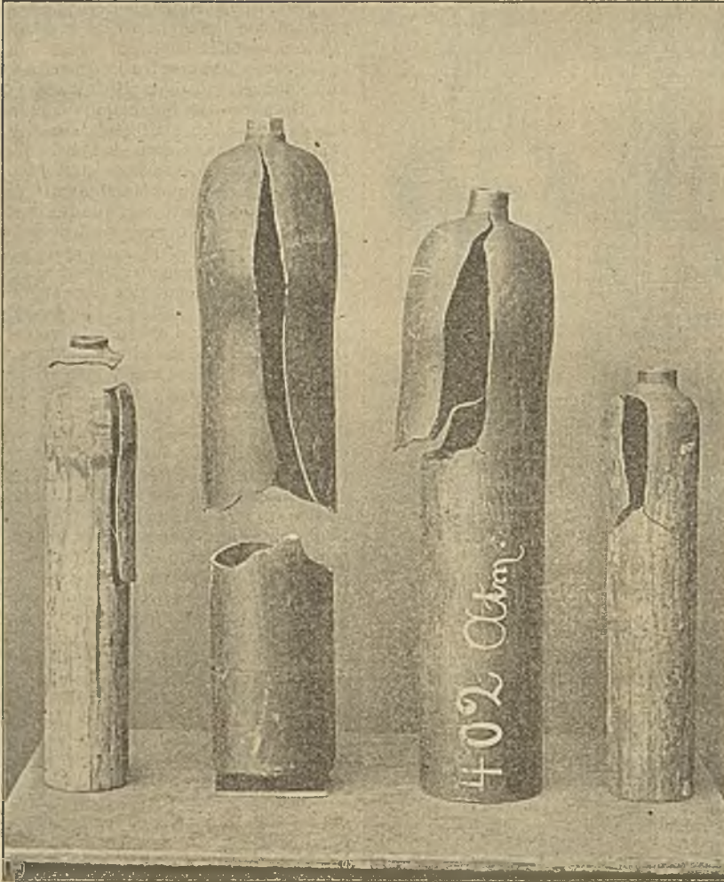
Fig. 1. Nahtlose Stahlflaschen durch Kaltziehen (Kaltpressen) hergestellt.
