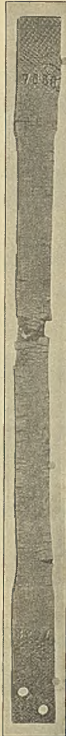
Fig. 20. Nach 32 monatlicher Aushängung im Seewasser an einer Platte aus reiner Aluminiumbronze. Stab Nr. 7 nach dem Zerreißen ;
