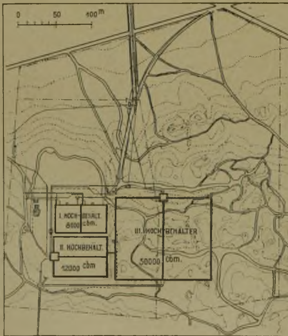
Abbildung 3 (links). Lageplan des Hochbehälters III neben den alten Behältern I u. II.
