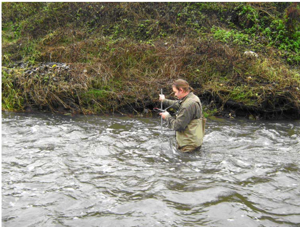
Fot. 1. Pomiar prędkości przepływu wody za pomocą młynka hydrometrycznego [fot. J. Pudło]
