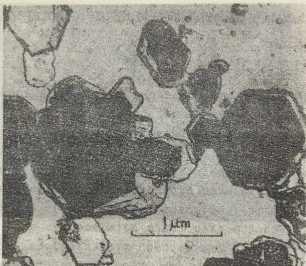
Rys. 37. Początkowe stadium wydzielania mosiądzu na podłożu cynku (cynkowana folia Al). Powłoka oddzielona od podłoża razem z wzmacniającą repliką węglową. Kąpiel 20 g/l Cu, 6 g/l Zn, 38°C, E = -1,420 , czas osadzania 1 min. Pow. 24000 x
