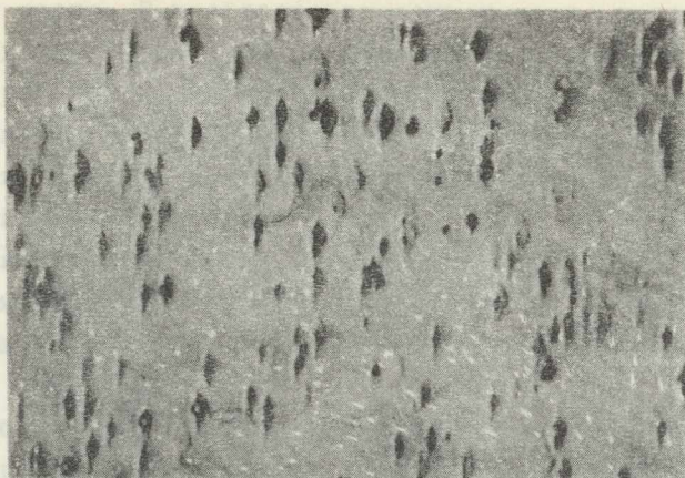
Rys. 15. Powierzchnia powłoki miedzi na podłożu (110) monokryształu. \eta = 350 mV, kąpiel 20-0, grubość ok. 0,7 \mu\text{m} . Dłuższa oś utworów rombów skierowana wzdłuż [100]. Pow. 1500x
