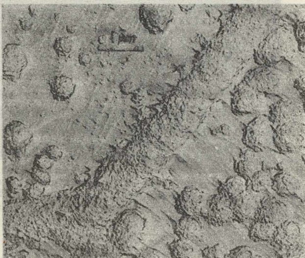
Rys. 38. Uprzywilejowany wzrost na granicy ziarn. E = -1,420 V, kąpiel 20-10, średnia grubość powłoki ok. 0,7 \mu\text{m} . Pow. 12000 x
