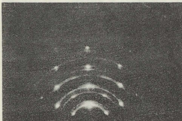
Rys. 30. Dyfraktogram z powierzchni powłoki na podłożu (111). E = -1,650 V, kąpiel 20-2, średnia grubość powłoki 0,7 \mu\text{m} . Kierunek wiązki elektronów wzdłuż [211] podłoża
