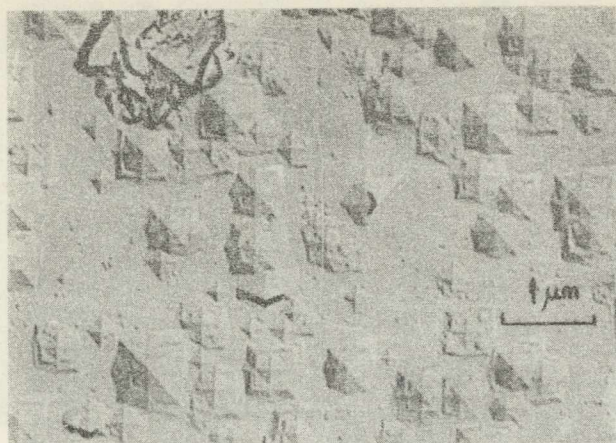
Rys. 33. Powierzchnia powłoki na podłożu (100) monokryształu. E = -1,870 \text{ V} , kąpiel 20-10, grubość powłoki ok. 0,7 \mu\text{m} . Pow. 12000 x
