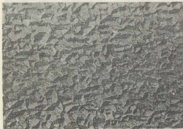
Rys. 14. Powierzchnia powłoki miedzi osadzonej na powierzchni (111) monokryształu przy \eta = 275 mV. Kąpiel 20-0, grubość powłoki około 0,7 \mu\text{m} . Pow. 12000\times
