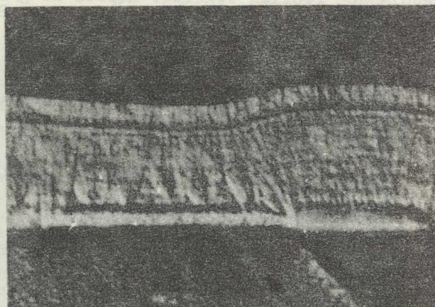
Rys. 40. Warstwowość struktury w powłoce uzyskanej przy E = -1,215 V przy temperaturze 25^\circ\text{C} . Kąpiel 20-2, Skośne oświetlenie. Pow. 2500 x. Traw. nadsiarcz. amonu
