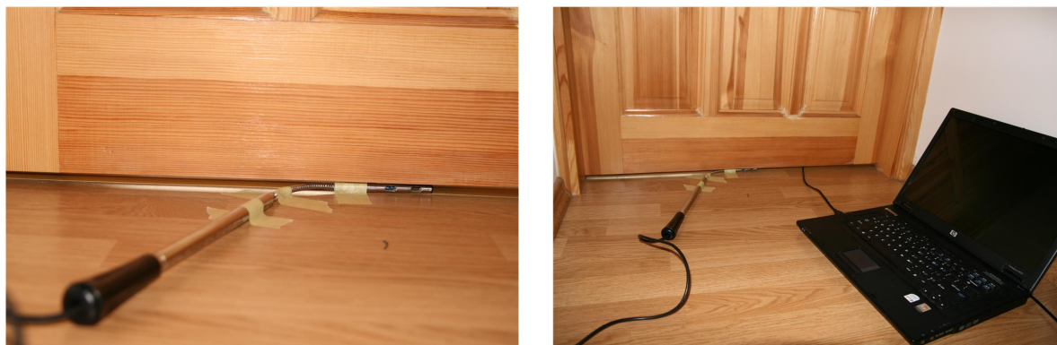
Rysunek 3.7: Pomiar termooanemometrem prędkości powietrza w szczelinie pod drzwiami
