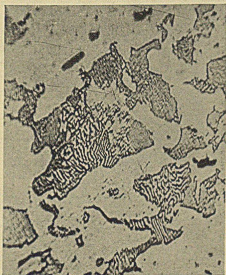
Abbild. 5. Geschmiedeter Stahl (0,45% C) polirt bei gleichzeitiger Aetzung. (Lin. Vergr. 1000.)
