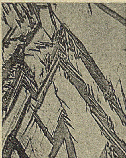
Abbild. 11. Cementstahl (1,5 % C) auf 1050° erhitzt und in Eiswasser gehärtet, polirt bei gleichzeitiger Aetzung. (Lin. Vergr. 1000.)
