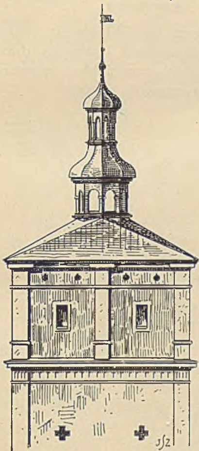
Rys. 51. Widok górnej części bramy zamkowej w Zbąszynie, koło Międzyrzecza, w księstwie Poznańskim. Założenie okien i układ pilastrów rozwija się na zasadzie połowienia (układ „dwudziału“.)
