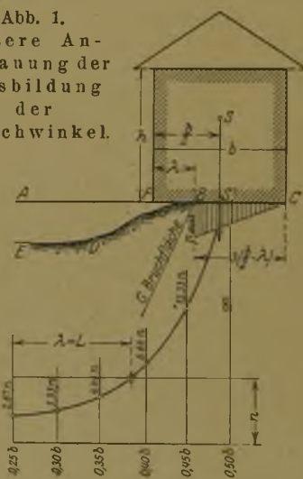
Abb. 10. Gebäude am Rand einer Senkungsmulde.
