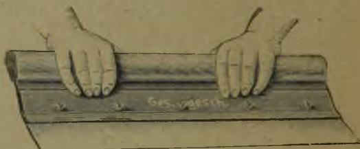
Abb. 4. Handhabung des Federspachtels.
