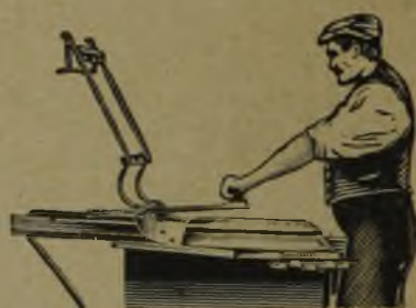
Abb. 2. Handhabung der Schlagplatte.
