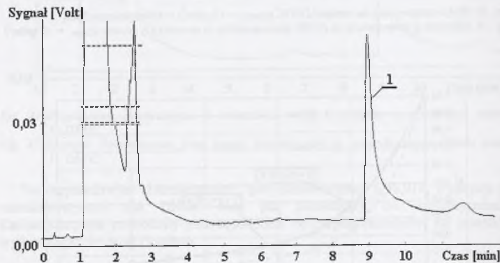
Rys. 38. Przykładowy chromatogram z oznaczania próbki w ozonowaniu: 1 - DNOC Fig. 38. Example chromatogram from sample determination in simple ozonization: 1 - DNOC
