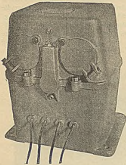
Figur 3 und 4. Gekapselter, wasserdichter Hauptstrom-Motor.
