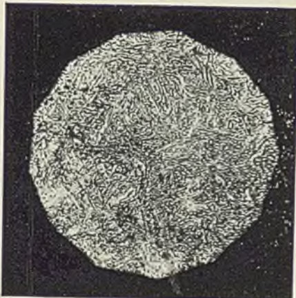
Abbildung 9. 3 Stunden bei 200° C. angelassen.
