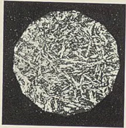
Abbildung 10. 3 Stunden bei 275° C. angelassen.
