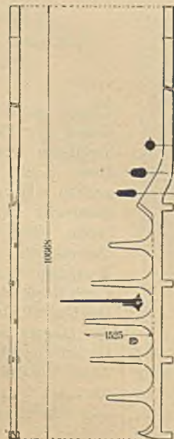
Abbildung 18. Ruder zum Hintersteven (Abb. 17).
