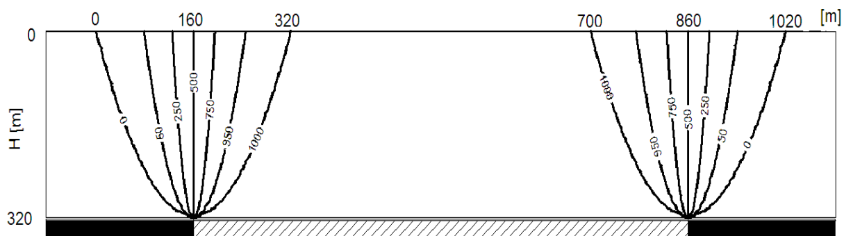
Rysunek 17 Rozkład obniżeń [mm] w siatce modelu.
