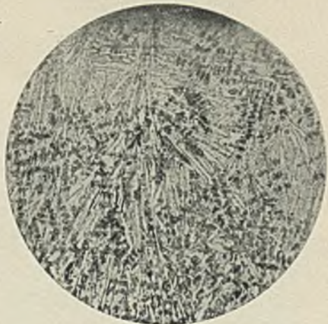
Lichtbild 3. Weißes Eisen, Härteschicht Randpartie. Kristallisationszentren weißer Zementit, dunkler Perlit.
