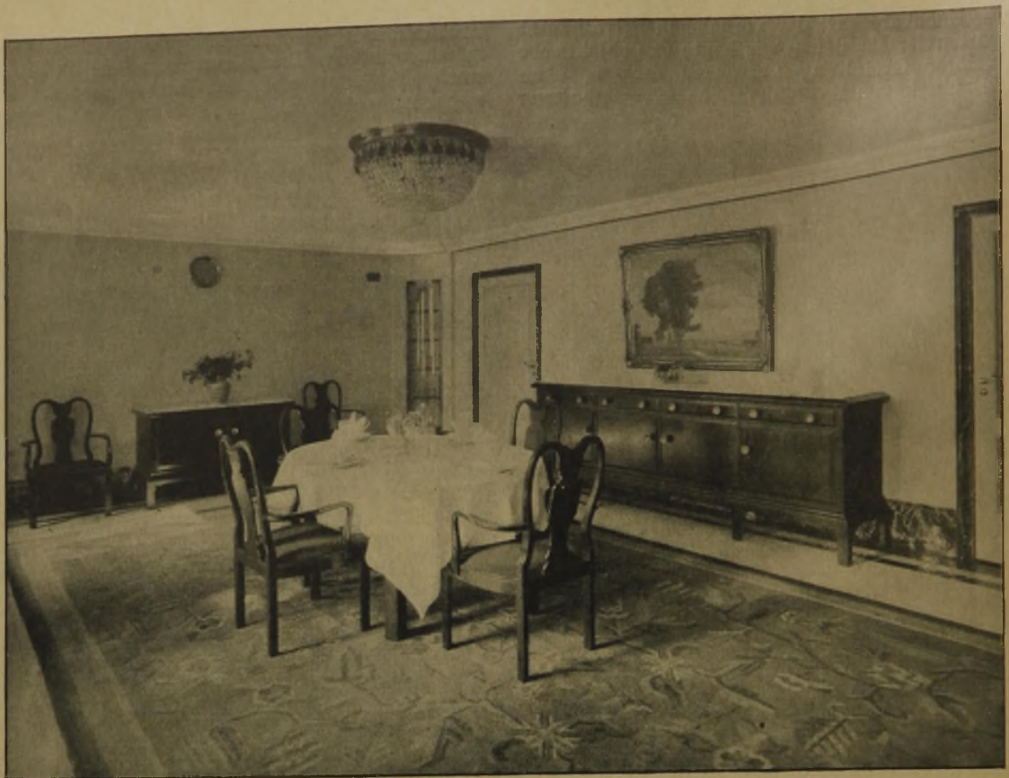
Abb. 9. Speisezimmer der Direktoren. (Mahagonimöbel, Marmorbelag blanc-clair mit schwarzem Fries und Sockel, Vitrine Bronze mit Spiegelglas.)
