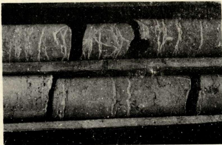
Fot. 2. Na tle jasnoszarego wapienia widoczny szereg szczelin zabliznionych gipsem lub kalcytem koloru bialego
