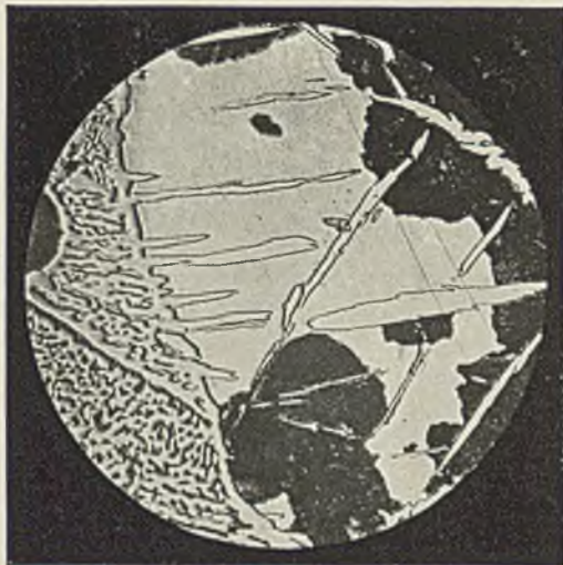
Abbild. 8. Austenitischer Zustand, \times 750 durch intensivstes Abschrecken erreichbar. Hell, im Relief: Zementit; hell, zurücktretend: Austenit; dunkel: Troostit.
