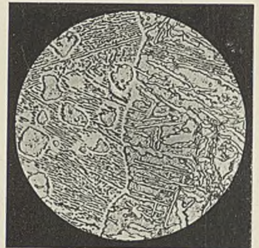
Abbild. 10. Gleichgewichtszustand unterhalb 700° C., \times 250 durch langes Glühen unterhalb 700° C. erreichbar. Hell, im Relief: Zementit; hell, zurücktretend: Ferrit.
