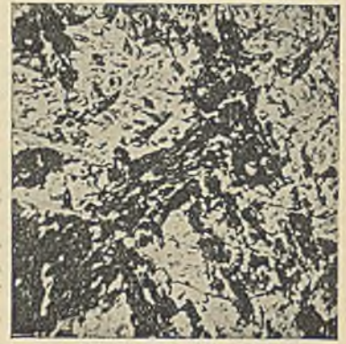
× 1000 Abbildung 2. Kohlenstoffstahl mit 1,15 % C. Auf 1000° erhitzt, bei 1000° abgeschreckt.
