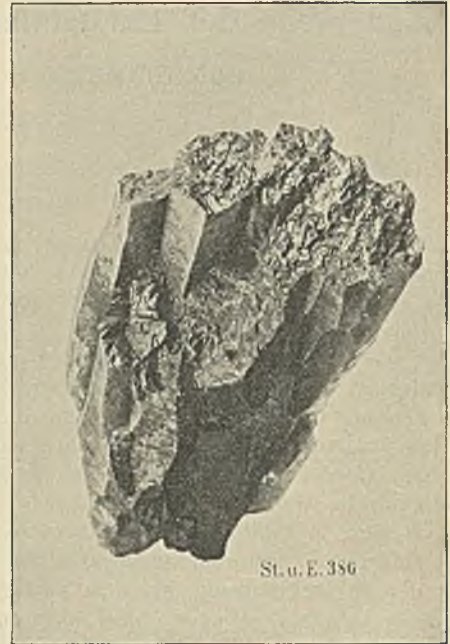
Abbildung 1. Stück einer Hochofensau.
