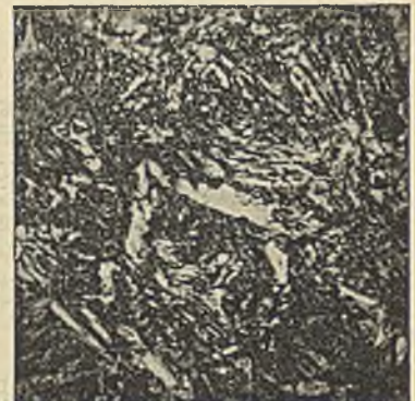
× 1000 Abbildung 4. 3,4 % C. Auf 1000° erhitzt, bei 1000° abgeschreckt.
