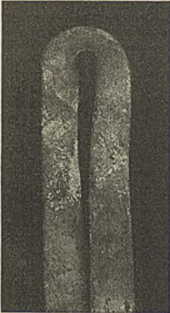
Abbildung 7. Biegeprobe von Elektrostaahl; geschweißt, langsam abgekühlt und dann in der Schweißstelle kalt gebogen.
