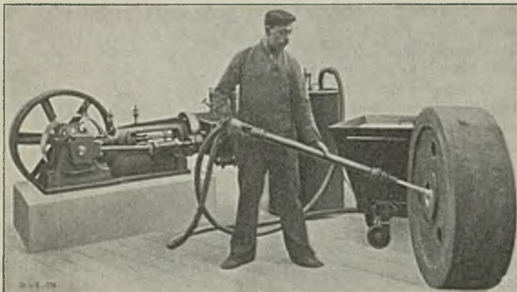
Abbildung 1. Freistrahlsandstrahlgebläse nebst Zubehörteilen. (Kompressor und Windkessel mit fahrbarem Sandkasten.)
