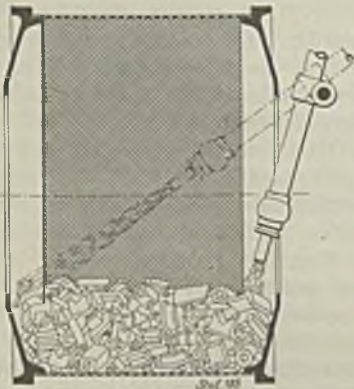
Abbildung 9. Trommel mit einer oder mehreren pendelnden Düsen.
