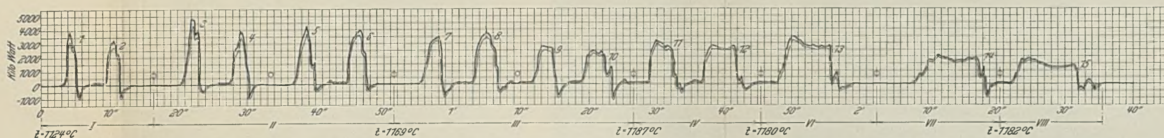
Abbildung 2. Weicher Block von 2,5 t Einsatzgewicht; C = 0,09, Mn = 0,596 % 43 kg/qmm Festigkeit; ausgewalzt in 15 Stichen auf 18,0fache Verlängerung.
