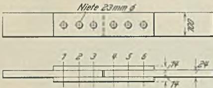
Abbildung 2. Probestab.
