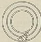
Der Schmelzraum ist in Form zweier oder mehr den Eisenkern spiral- bzw. schleifenförmig umgebender Rinnen ausgeführt, deren Enden durch eine Brücke *a* in leitender Verbindung miteinander stehen. Hierdurch wird erreicht, daß das Schmelzgut einen verhältnismäßig geringen Querschnitt und große Länge, somit einen hohen Widerstand erhält.
