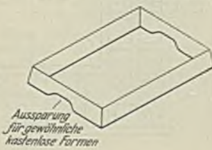
Abbildung 6. Rahmen zum Einlegen in die Abzugkasten zum Stapeln kastenloser Formen.
