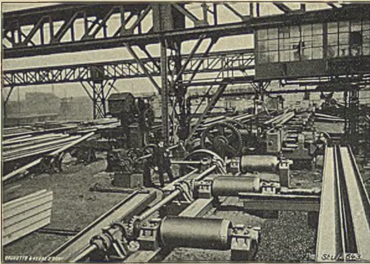
Abbildung 23. Rollgang und Richtmaschine für schwere Profile.
