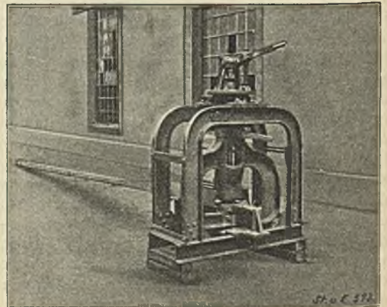
Abbildung 3. Nestmannscher Apparat zum Durchschlagen von Feineisen bis 18 mm \phi .
