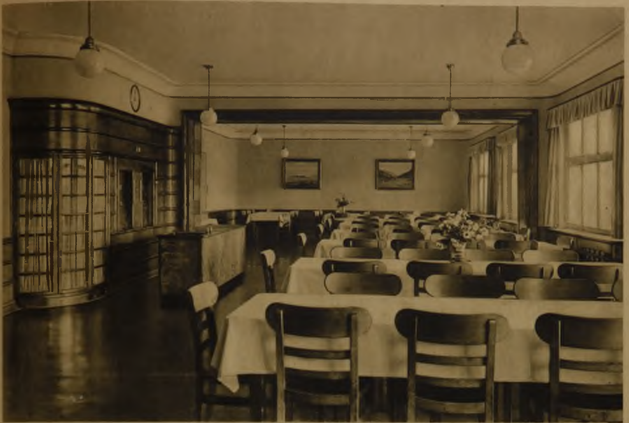
Speisesaal mit Harmonikatrennwand, links Speisenaufzüge und Anrichte. Holzwerk und Stühle in Birke silbergrau, Wände grün Linoleum pompejanischrot
