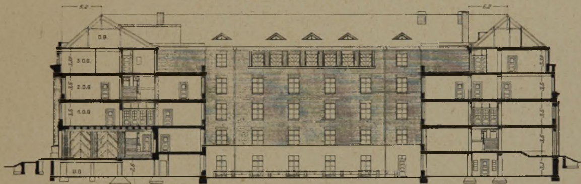
Abb. 5. Längsschnitt in der Achse des Haupteingangs von Rütterscheider nach Bismarckstraße (1:500).
