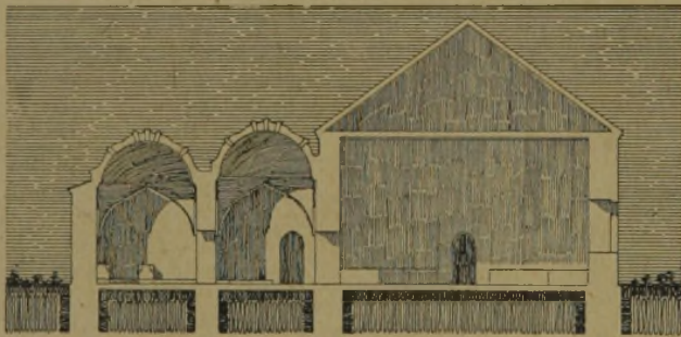
Abb. 19. Schnitt in der Achse I—K der Abb. 17. Jokary Basar Hamam in Ismid. (1:300)
