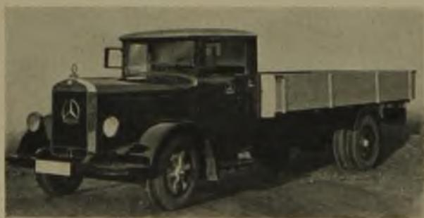
8 Lastkraftwagen Typ Lo 3500 für 3½ t Nutzlast mit 95 PS-Dieselmotor 6 Zyl. Typ OM 67 (Mercedes-Benz)
