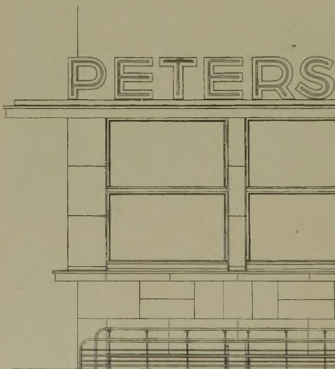
Metallschiebefenster im Erdgeschoß 1:30
