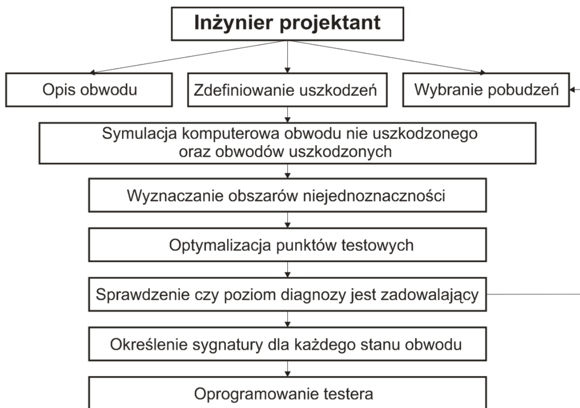
Rys. 2-7 Etapy konstrukcji sygnaturowego słownika uszkodzeń [Rut03].
