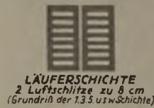
LÄUFERSCHICHTE 2 Luftschlitze zu 8 cm (Grundriß der 1.3.3. usw. Schichte)
