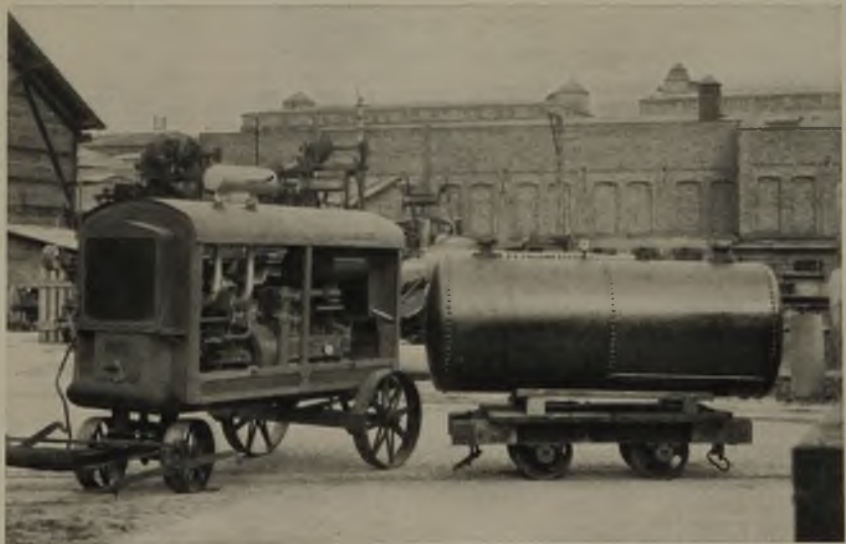
8 Kompressoren und Windkessel für Preßluftarbeiten
