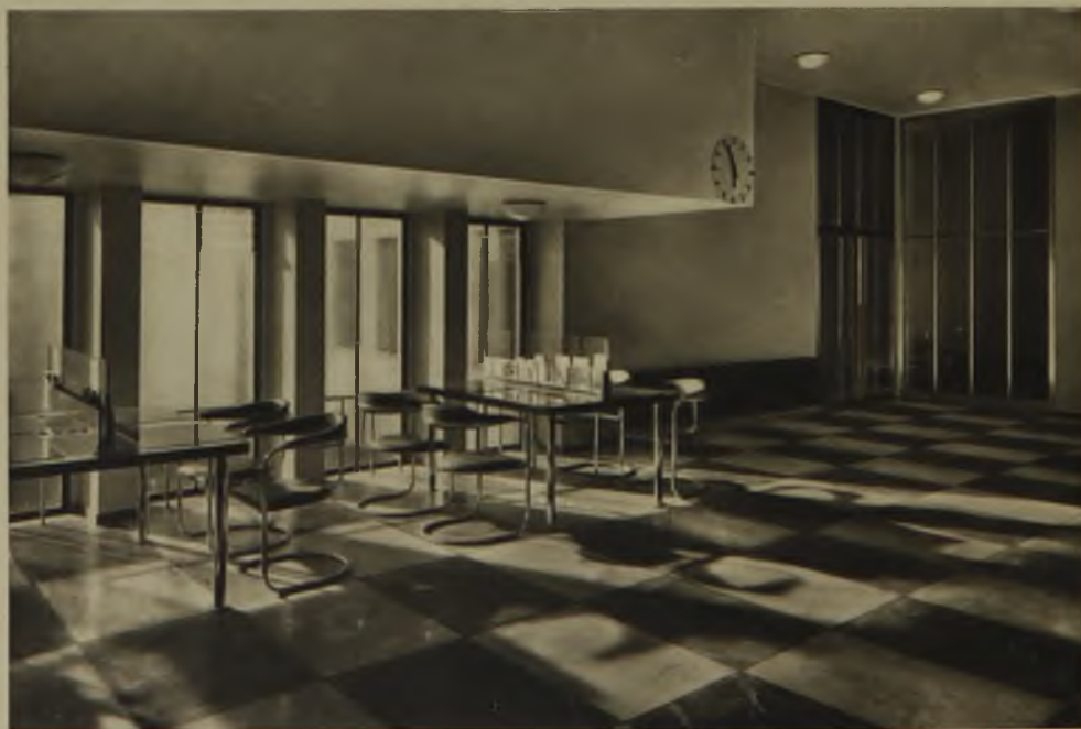
Kassenhalle. Fußboden geschliffener schwarzer und weißgrauer Marmor. Wand heller Anstrich. Eisenfenster- rahmen rot gestrichen. Innere Trennwände in Bronzerahmen, Mattglas als raumabschließender und doch lichtdurchlassender Stoff
