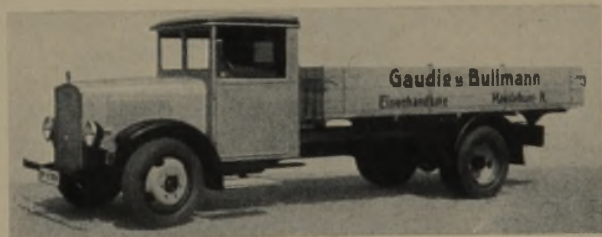
2-Tonnen-Schnell-Lastkraftwagen mit 50-PS-Dieselmotor Friedrich Krupp A.-G., Essen
