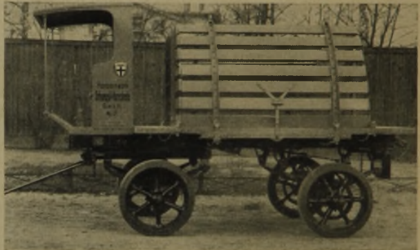
5 Spezial-Anhängerausführungen wie dieser 5-t-Anhänger für Sandmauersteine können mitunter Kostenrechnungen sehr zu ihrem Vorteil verändern.
