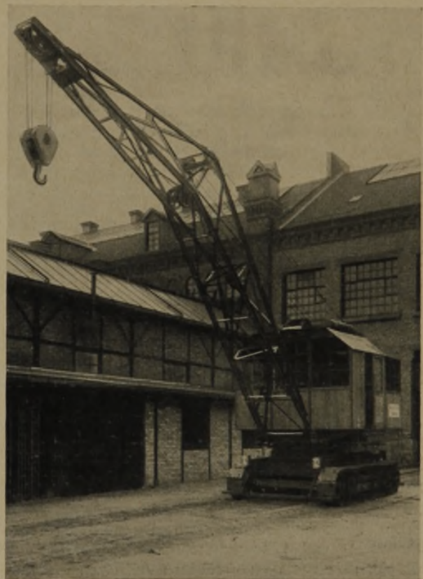
6 Diesel-Drehkran. Dieser auf Raupenfahrgestell dieselgetriebene Drehkran bedeutet für manche Zwecke eine starke Abkürzung der Bauzeit
