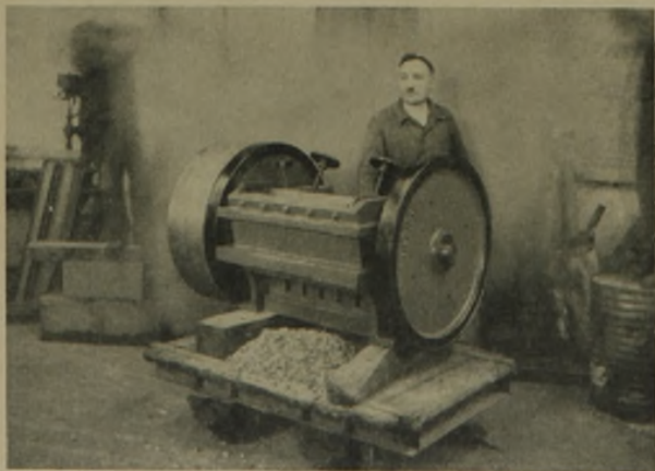
1 Splittbrecher zur Erzeugung von kubischem Korn
