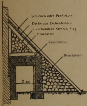
6 Schutzraum über der Erdoberfläche , wie er in der ausländischen Industrie Anwendung findet
