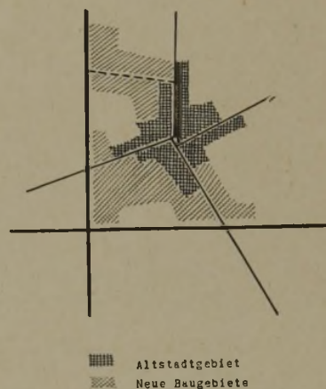
2 Schlechte Verkehrsführung. Die Hauptsammelstrecken sind zu weit draußen angeordnet. Die zusammenhängende Baumasse muß weiterwachsen, und die Altstadt bleibt doch ein Verkehrs-hauptgebiet
