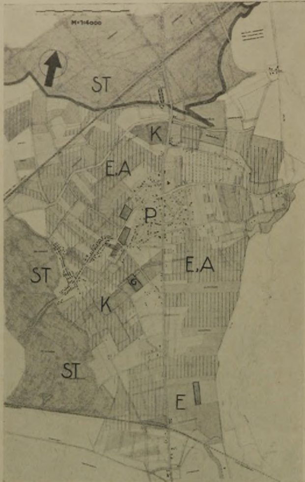
3a. Verwaltungsplan mit Staatsforst = St geschützt (stark umrandet), ungeschützt (nicht umrandet), Gemeindebesitz = G, Kirchenbesitz = K. Aufgeteilte (parzellierte) Flächen = P, Erbhofland = E und Aufschließungsvertragsflächen = A. Die beiden letzten durchdringen sich. Die Abbildung zeigt den Plan einer Bauernfeldmark, für die in weitestem Maß Aufschließungsverträge abgeschlossen sind. Die langen Streifen der bäuerlichen Felder führen entweder zu unorganischen Siedlungsstreifen oder bei Regelung durch einen Siedlungsplan zu Unglücksgebilden, wenn streifenweise aufgeteilt wird. Da derartige Möglichkeiten vermieden werden müssen und außerdem ein Bedarf nach so viel Siedlungsland, wie es die Aufschließungsverträge vorsehen, nicht nachweisbar ist, so hat sich in diesem Falle der Wirtschaftsplan in Gegensatz zu den Aufschließungsverträgen gestellt und die Wohnsiedlungsfläche wesentlich eingeschränkt (vergleiche 3 b). Eine Ausfechtung dieses Gegensatzes steht noch aus. Maßstab 1 : 40 000.
