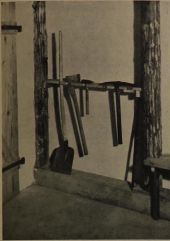
2 (links) Wandbrett mit Arbeitsgerät zum Gebrauch bei Verschüttung oder Hauseinstürzen
