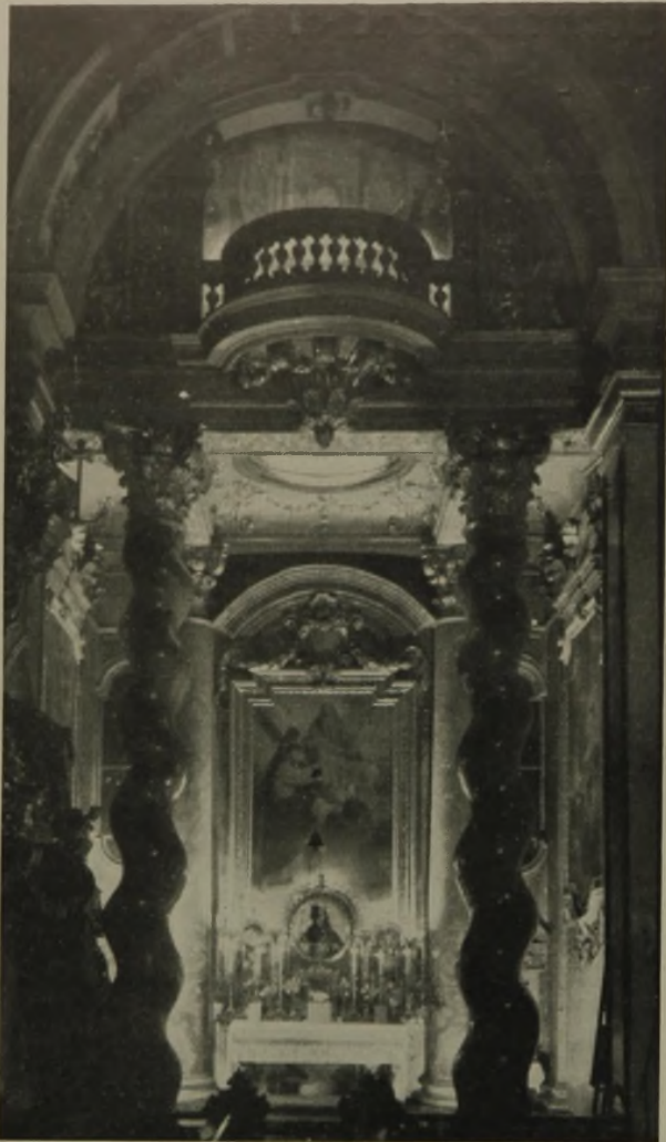
3 Altarbeleuchtung in der alten Universitätskirche in Wien. Entwurf: Prof. Grom-Rottmayer. Ausführung: Dr.-Ing. Leopold Fink und Dr.-Ing. Hans Hofmann. Hinter der Tabernakelwand 3×75 W. (ohne Blende), rechts und links hinter den Säulen je 100 W. im Kegelscheinwerfer, auf der Empore (gegen die Leibung der Deckenöffnung gerichtet) 100 W.
