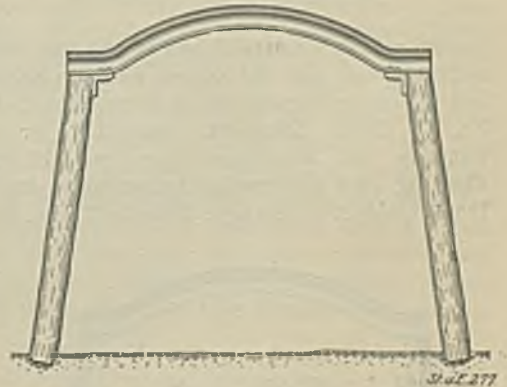
Abbildung 5. Kappe, gebogen aus Eisenbahnschiene, Beine aus Holz.
