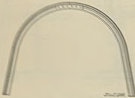
Abbildung 16. Eisernes Streckengestell in offener Bogennorm aus Eisenbahnschienen.
