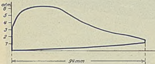
Abbildung 6. Druckluftdiagramm beim Zerschneiden eines Blockes von 270 mm □ Querschnitt (65 kg Festigkeit).
