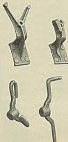
Abbildung 5. Maschinenteile, kalt verbogen.
