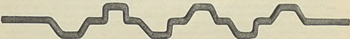
Abbildung 10. Mehrfach gekröpfte Kurbelachse aus Elektrostahl für Dreschmaschinen, 2200 mm lang und 45 mm Durchmesser.
