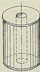
Büchse für Lunkerthermit.
